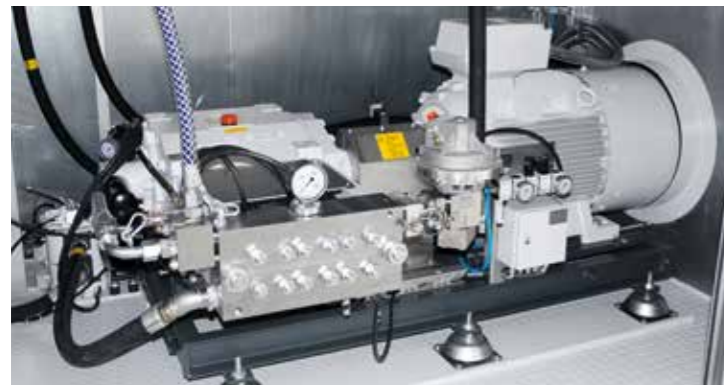
Prüfpumpenaggregat DP724 E für die zyklische Druckprüfung in Container-Ausführung
