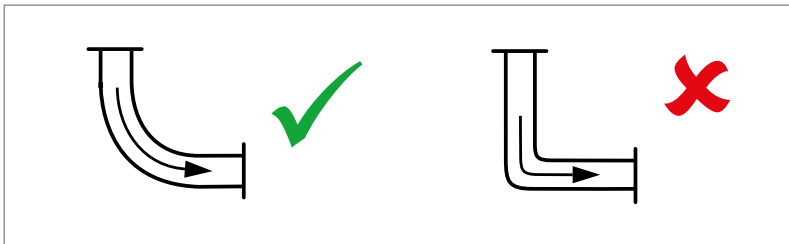
Abbildung 15: Lange Bögen besser als scharfe 90° Umlenkung
