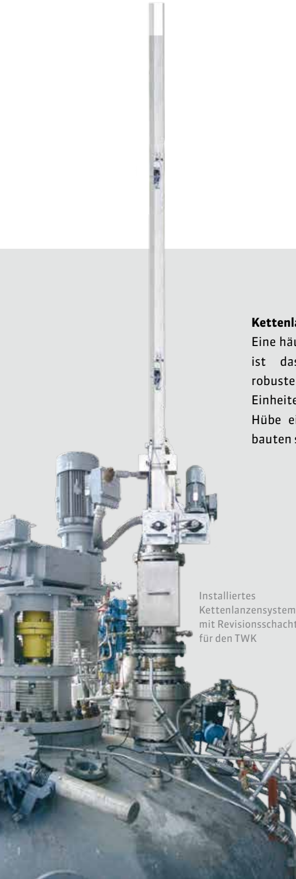
Lanzensystem mit Reinigungsvorrichtung für den TWK
