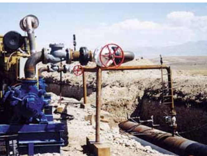
Prüfpumpenaggregat DP3-10 E mit Direktantrieb auf Industriefahrgestell
