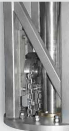
Detail: Kettenantrieb der Lanze
