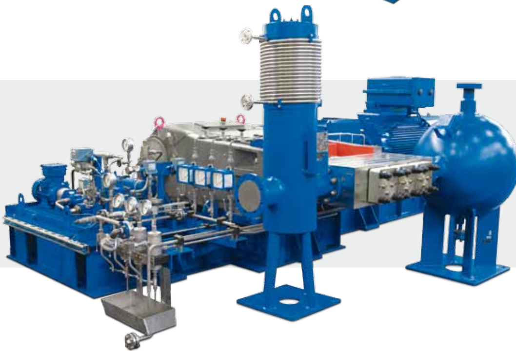
Hochdruck-Pumpenaggregat KD823 für flüssiges NH 3 mit teilweise beheiztem Saugpulsationsdämpfer, druckseitigem Resonator und Schmierölsystem
