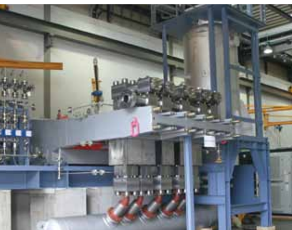
Hochdruck- Pumpen- aggregate P5-96 und P3-96 für die Kohlemaische- förderung
