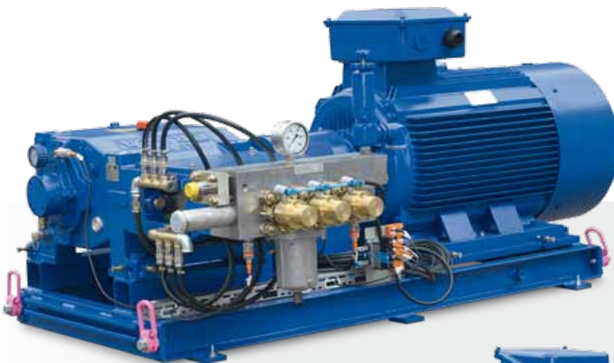
Hochdruck-Pumpenaggregat KD724 mit Saugventilauslösung für schnelle und präzise Lastwechsel sowie Sensorik für Betriebsdatenerfassung
