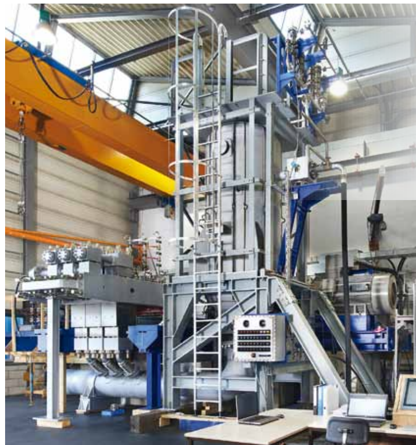
Hochdruck- Pumpen- aggregate P5-96 und P3-96 für die Kohlemaische- förderung
