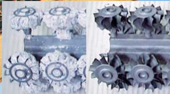
精密铸造件清理无残渣
