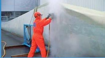
清洗,油漆剥离和粗磨-也可应用在易损害的表面
