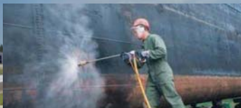
油漆剥离和除锈-及易损坏的表面
