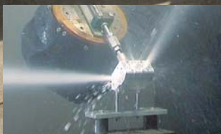
去除毛刺和精密部件的加工残渣的内部清洗
