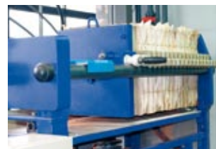
■ Очистка фильтровальной ткани
