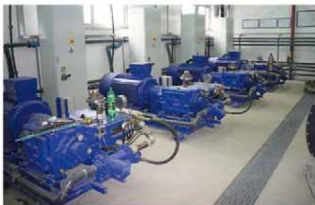
Сверху: насосная камера очистной установки высокого давления Снизу: небольшой фрагмент нашего предлагаемого ассортимента
