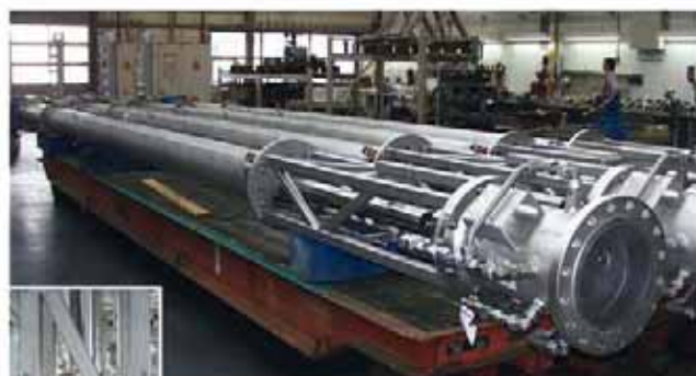
Газонепроницаемые трубки с цепным приводом
