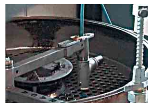
Modelo típico de unidad de bomba para alta presión URACA aplicada a la limpieza de intercambiadores de calor.
