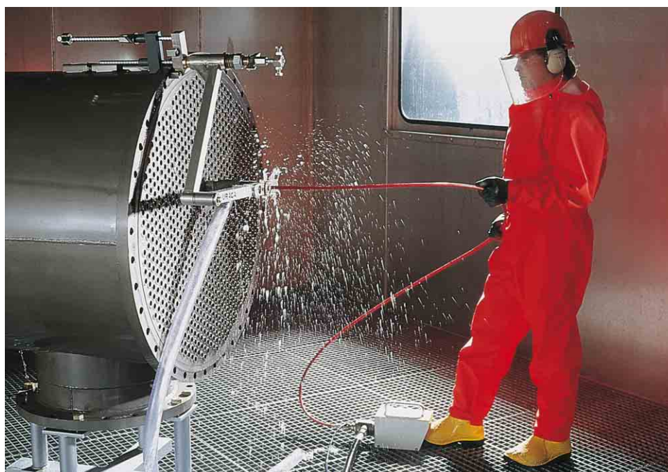
Arriba: Dispositivo de sujeción de la lanza para evitar latigazos. Abajo: Uniforme de protección.
